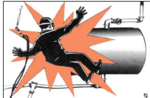
Figure 1 : explosion due à un dégazage incomplet
